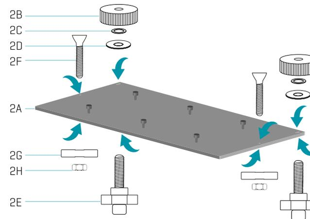
Um die Basisplatte [2A] im Fahrzeug Heck zu positionieren, müssen folgende Schritte beachtet werden:
