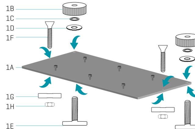
Um die Basisplatte [1A] im Fahrzeug Heck zu positionieren, müssen folgende Schritte beachtet werden:
